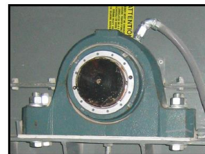
Sensore per cuscinetti su trasportatore a nastro
